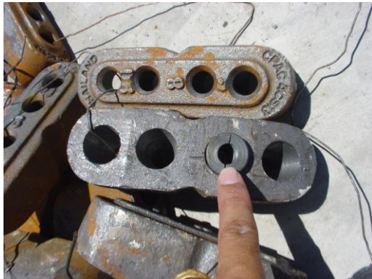
๘) การถอด PLASTIC FORMER และการใส่จ่าปา ( JAWS )
